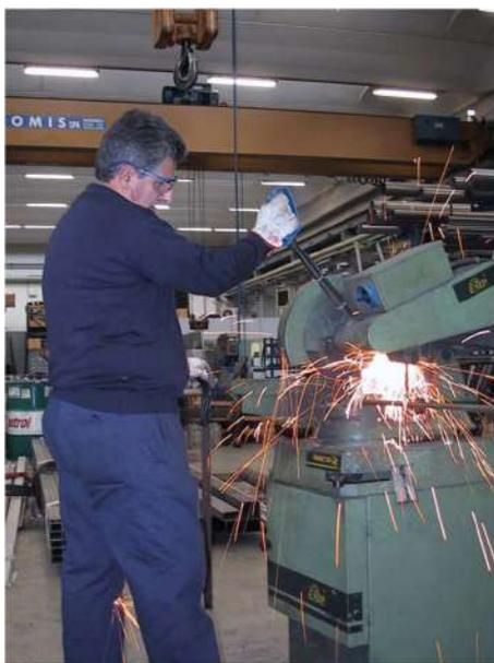
**Figura 12 – Operazione di troncatura**
