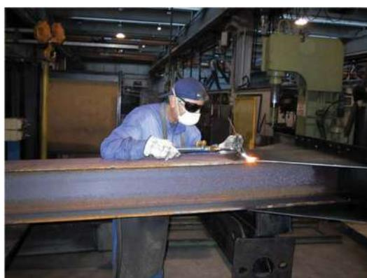
**Figura 25 – Saldatura ossiacetilenica con materiale di apporto**
