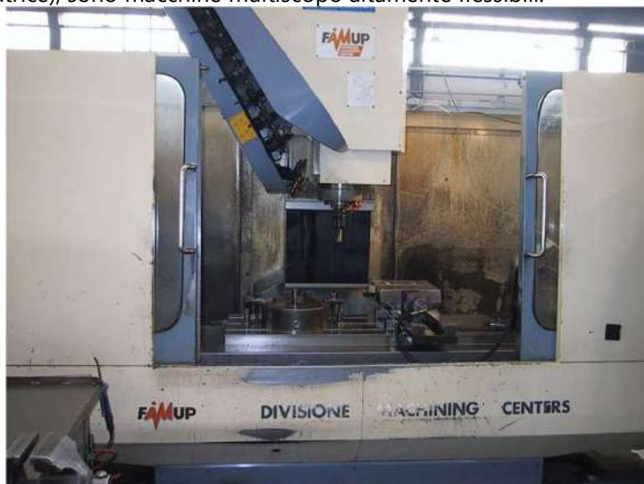
**Figura 30 – Vista di insieme centro di lavoro a controllo numerico**
