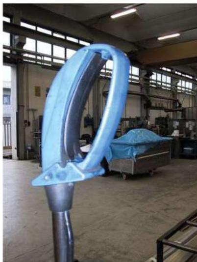
**Figura 11 – Interruttore a pressione continua posto sull'impugnatura**
