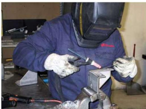
**Figura 20 – Saldatura tipo TIG**
