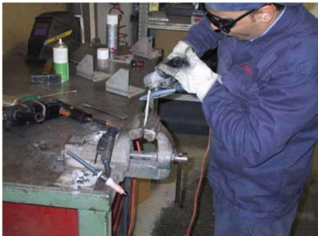
**Figura 18 – Preparazione alla saldatura**
