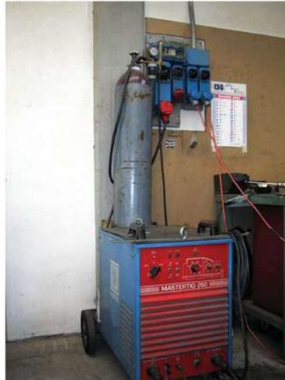
**Figura 17 – Generatore e bombola di gas inerte**
