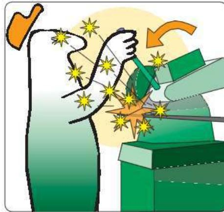
**Proiezione di materiali** (trucioli) con possibilità di gravi danni agli **occhi**.
