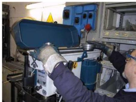
**Figura 7 – Cambio della velocità di rotazione del mandrino**
