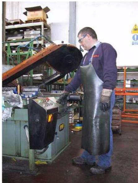
**Figura 29 – Operazione di taglio con il pulsante di azionamento**
