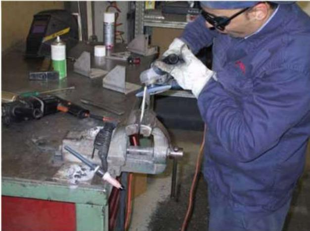
**Figura 18 – Preparazione alla saldatura**
