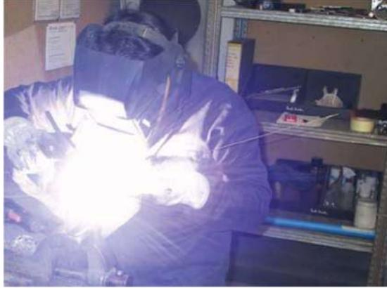
**Figura 22 – Operazione di saldatura**
