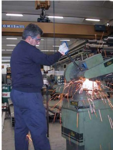
Figura 12 – Operazione di troncatura
