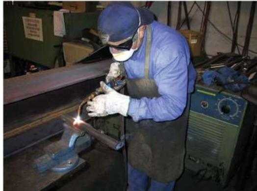
**Figura 24 – Saldatura ossiacetilenica senza materiali di apporto**
