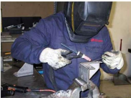
**Figura 20 – Saldatura tipo TIG**
