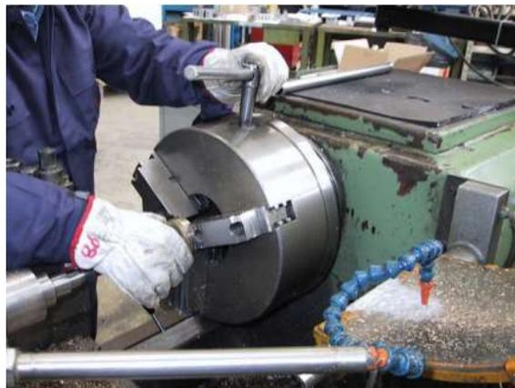
**Figura 2 - Operazione di serraggio del pezzo**
