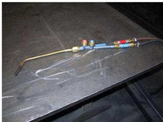
**Figura 23 – Cannello da saldatura con i rubinetti di acetilene (rosso) e di ossigeno (blu)**
